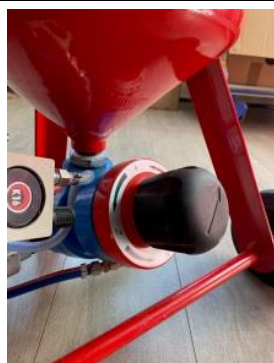
Option : Doseur abrasif piloté pneumatiquement
